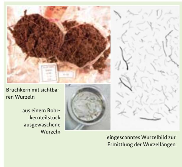
Abb. 4.14: Bestimmung der Durchwurzelungsintensität durch Auszählen sichtbarer Wurzeln an Bruchkernen und durch Auswaschen der Wurzeln aus Bohrkernteilstücken (Foto: S. Schroetter, JKI-PB)
