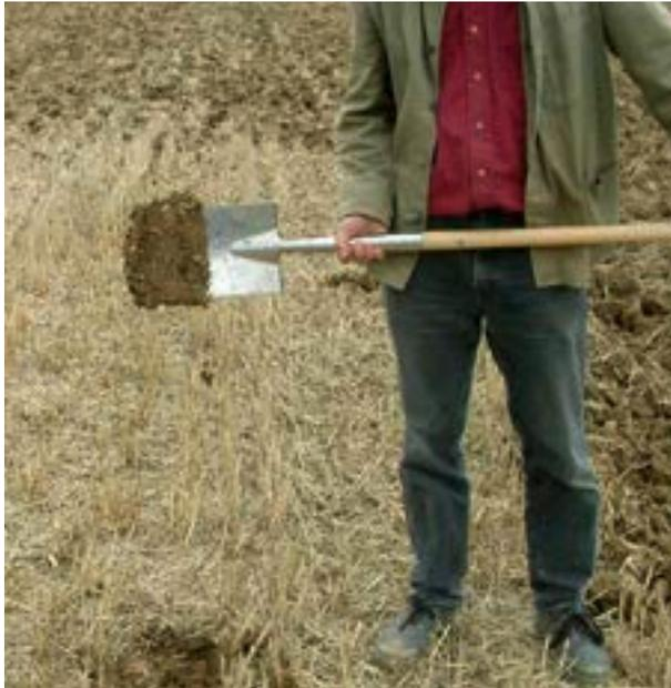
Abb. 5.14: Spatenprobe: Durch hohen Feuchtegehalt klebt der Boden am Spaten (Foto: H. Voßhenrich)
