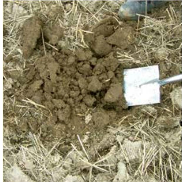
Abb. 5.15: Spatenprobe: Der Boden ist angetrocknet und fällt locker (Foto: H. Voßhenrich)
