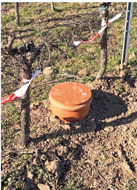
Saugkerze in einem Kunststoff-Schutzschacht im Unterstockbereich.
