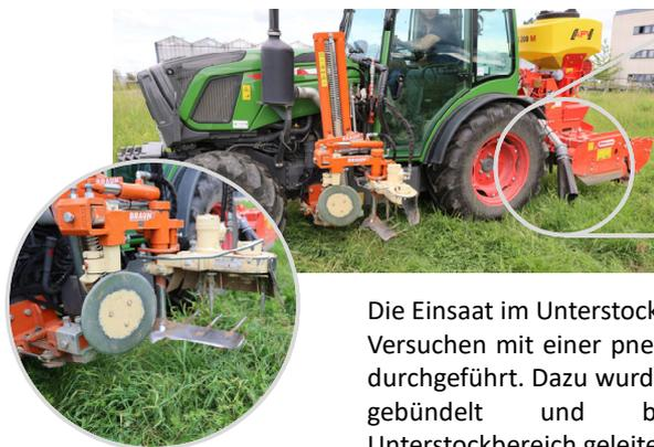
Die Einsaat im Unterstockbereich wurde in ersten Versuchen mit einer pneumatischen Sämaschine durchgeführt. Dazu wurden die Saatgutschläuche gebündelt und beidseitig in den Unterstockbereich geleitet.
