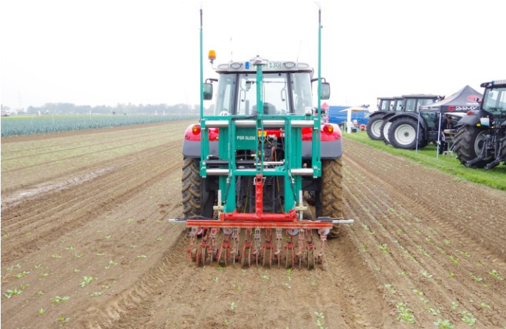
Abbildung 1: Verschieberahmen mit Hacktechnik für Spinat für eine Genauigkeit von \pm 1 cm
